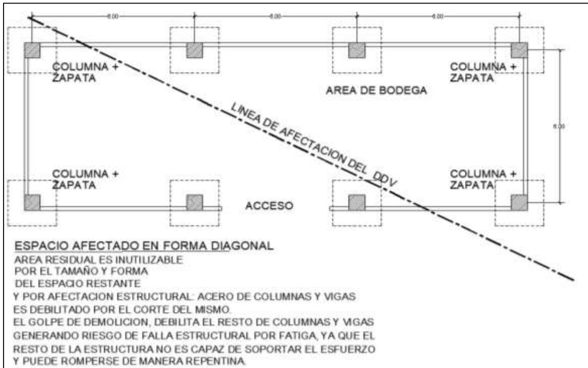
Figura 55 – Espacio afectado en forma Diagonal en área residual inutilizable
